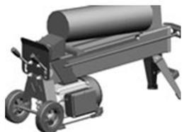
Relâchez les deux boutons de commande pour que le poussoir de bûches soit complètement rétracté. Placez une cale triangulaire en bois sous la bûche et activez le poussoir de bûche pour pousser la cale sous la bûche coincée. Répétez cette procédure en augmentant progressivement la taille des cales en bois jusqu'à ce que la bûche coincée soit libérée.
