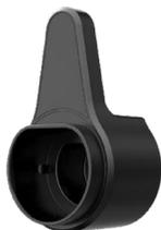
Une prise vide pour une fiche de type 2 est fournie avec la borne de recharge. La prise vide doit être installée dans un endroit pratique à proximité de la station de charge. Lorsque la borne de recharge est en mode veille, insérez la fiche de charge dans une prise vide pour la protéger des dommages.
