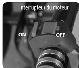
L'interrupteur du moteur est situé sur la poignée du panneau de commande.
