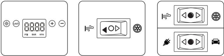
Appuyez sur «UNIT» pour sélectionner l'unité d'affichage. Appuyez ensuite sur «<->» ou «>+» pour régler la pression souhaitée. Appuyez sur le commutateur de mode pour passer en mode haut volume et le gonflage commencera automatiquement et s'arrêtera automatiquement au niveau de pression désiré. Lorsque le gonflage est terminé, mettez les deux interrupteurs en position OFF.
