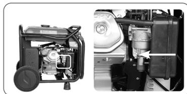
Pour vidanger l'essence du carburateur, fermez le robinet de carburant et attendez que le générateur refroidisse un peu. Placez le réservoir sous le carburateur et dévissez le bouchon de vidange d'essence sur le carburateur (voir fig.). Ne laissez pas le carburant couler sur le générateur. Resserrez la vis.
