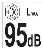
Le niveau de bruit est indiqué à une distance de 7 m. Pour différents modèles, ce niveau est différent. Tous les niveaux sont donnés dans la section «CARACTÉRISTIQUES TECHNIQUES DES GÉNÉRATEURS».
